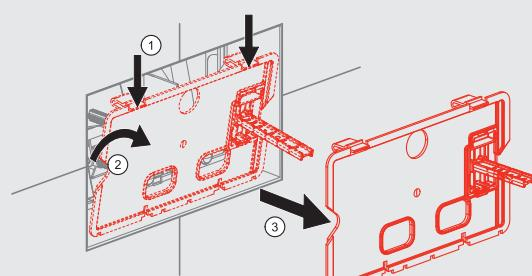
**5. Vyndejte splachovací mechanismus, který ovládá táhlo vypouštěcího ventilu.**
