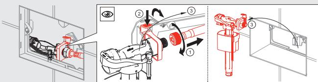
**8. Při plně napuštěné nádržce spláchnete a vyjměte vypouštěcí ventil z nádržky tak, aby došlo k úplnému vypuštění (vyprázdnění nádržky). Vypouštěcí ventil můžete vyjmout.**
