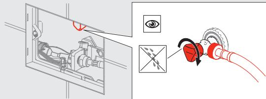
**7. Odpojte a vyjměte napouštěcí ventil.**
