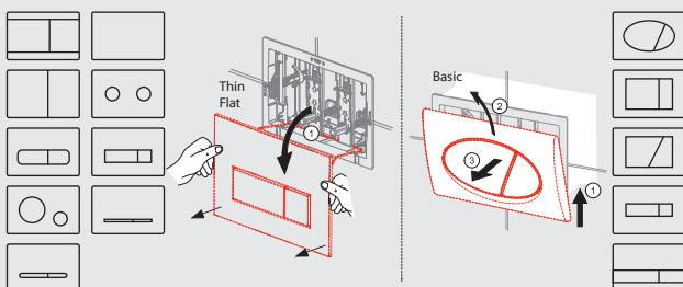
**2. Sejměte celé tlačítko z WC modulu.** Nejprve uvolněte zámky sloužící k zajištění rámečku tlačítka. Poté pomocí bočních svorek uvolněte samotné tlačítko a sundejte ho.
