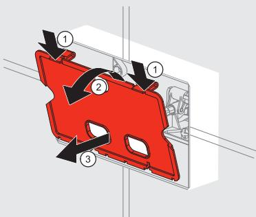
**2. Sejměte celé tlačítko z WC modulu.** Nejprve uvolněte zámky sloužící k zajištění rámečku tlačítka. Poté pomocí bočních svorek uvolněte samotné tlačítko a sundejte ho.
