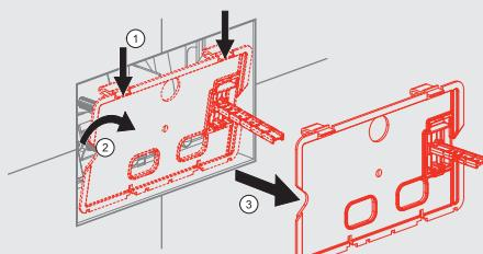
**5. Vyndejte splachovací mechanismus, který ovládá táhlo vypoušťecího ventilu.**
