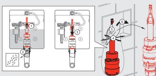
**9. Odstraňte nečistoty na dně nádržky.** Nádržku vypláchněte pomocí hadičky odpojené od napouštěcího ventilu
