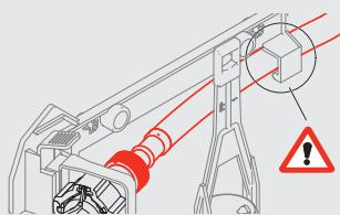
**7. Namontujte všechny součásti modulu zpět.** Začněte táhlem vypoušťecího ventilu (nezapomeňte ho uchytit k mechanismu vypoušťecímu ventilu), poté nainstalujte zpátky vnitřní desku (musíte slyšet kliknutí) a nainstalujte zpátky ovládací tlačítka.
