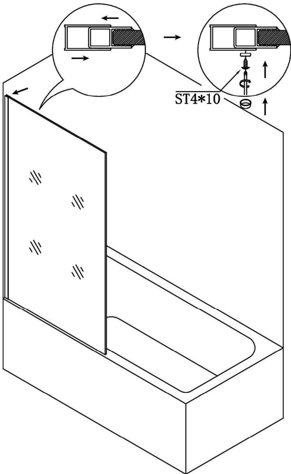
Krok 6: Montáž stabilizačného profilu a tesnenia
