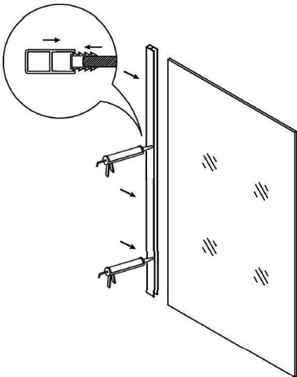
Vložte sklo do profilu, nezabudnite mať klinové tesnenie medzi profilom a sklom zaistené silikónom.
