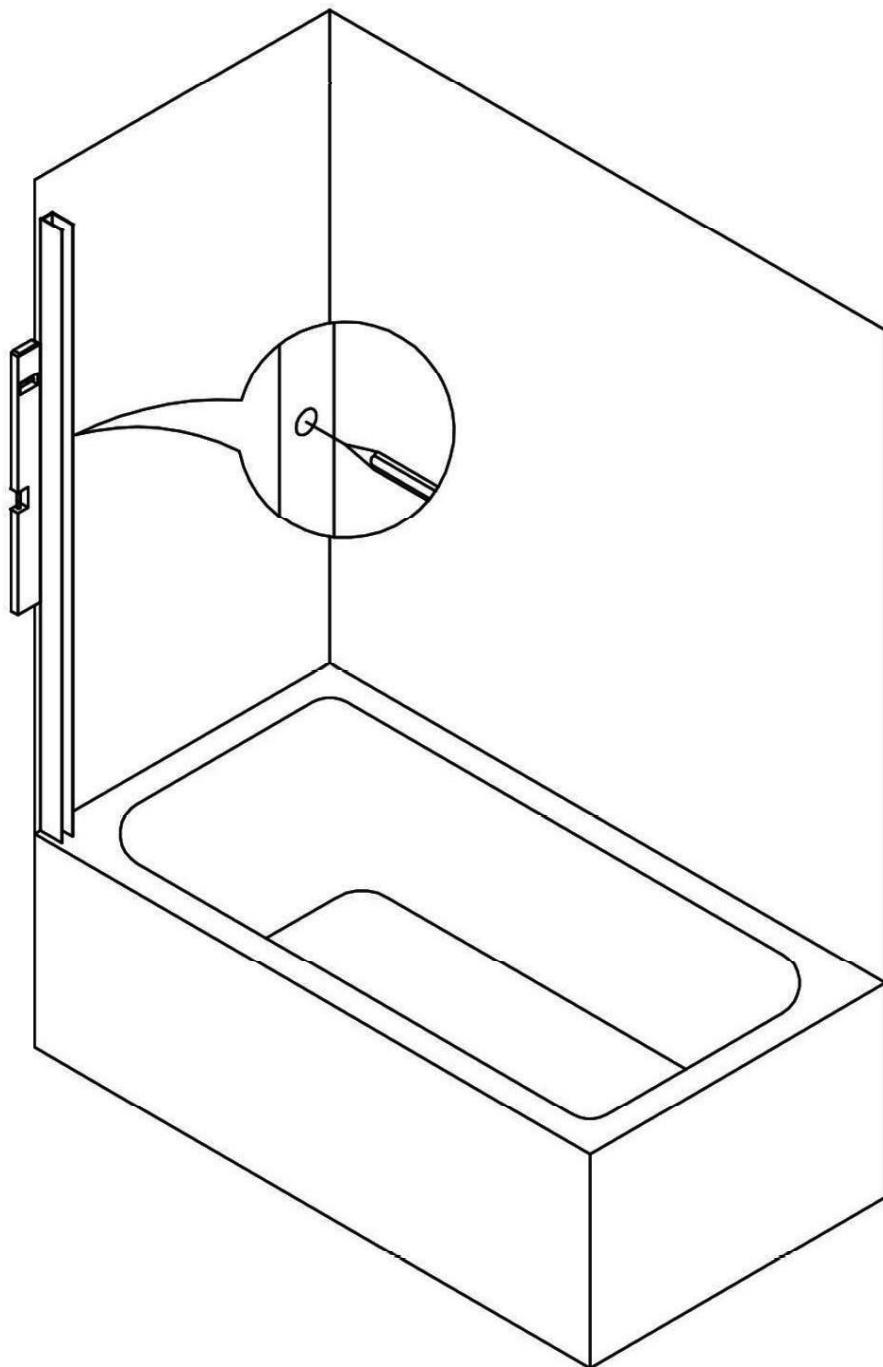
Priložte nástenný profil k stene a označte miesto, kde by ste mali v ďalšom kroku vyvŕtať otvory na montáž prvkú na stenu.
