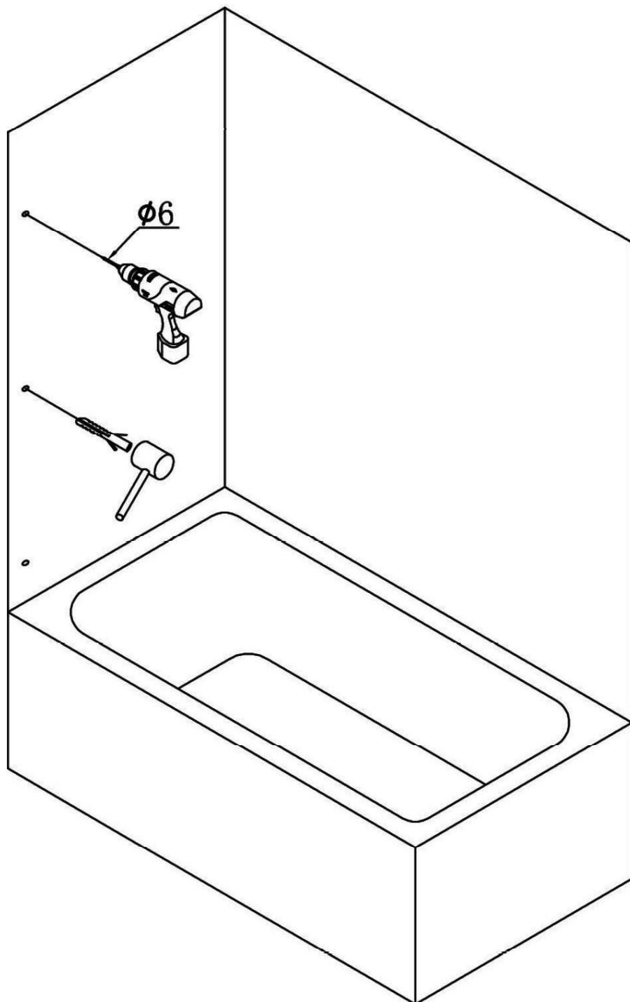
Do nástenného profilu a steny vyvŕtajte symetricky 3 otvory s priemerom 6, potom vložte montážne kolíky do steny a spojte nástenný profil so stenou pomocou montážnych skrutiek.
