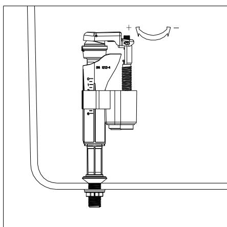
3. Upravte hladinu vody pomocí zašroubování nastavovacího šroubu, hladina vody by měla být pod úroveň přepadu ne menší než 2 cm.
