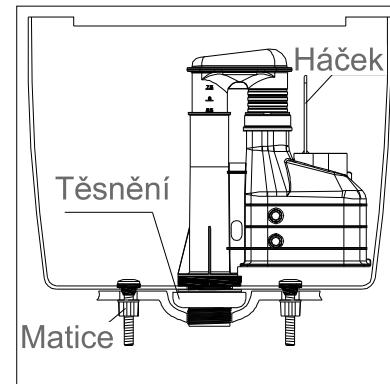
Vložte těsnění do
